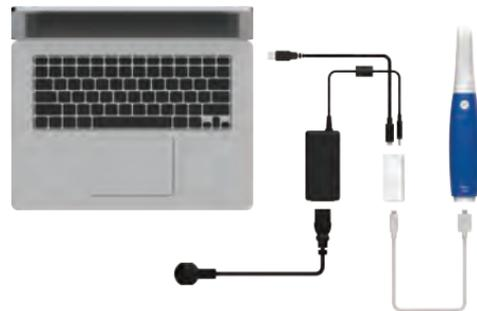
① Sluit de USB-kabel aan op de Power Hub.
