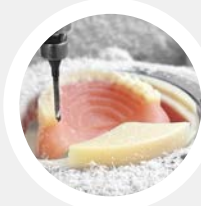
2. Frässchritt Prothese heraus- trennen
