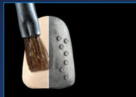
Mit sauberem Leitungswasser (kein Dampfstrahler) reinigen und mit sauberer Druckluft (ölfrei) sorgfältig trocknen.
