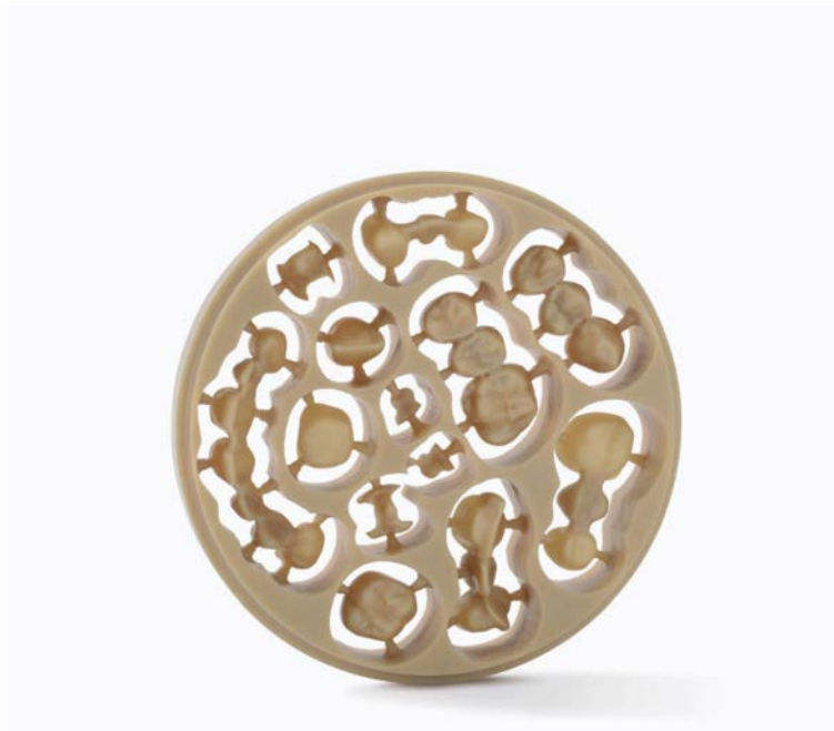
Abb. 2: Verblendung leicht gemacht: Mit dima Mill Zirconia HT arbeiten Zahntechniker besonders wirtschaftlich und zeitsparend, da das Material an die Dentinfarben natürlicher Zähne adaptiert wurde.
