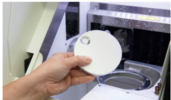
**Für die Zukunft gut aufgestellt:** Aus dima Zirconia fräst die cara DS mill 2.5. die erste Krone.
