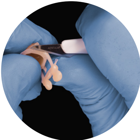
Abb. 22: Überschussentfernung mit dem Skalpell.
