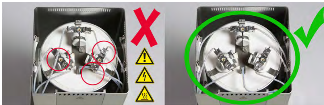
Fig. 4-2 Korrektes Verlegen der Heizelement-Anschlussdrähte
