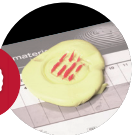
Abb. 48 – 50: Korrekt dosierte Stränge (oben). Im Vergleich: Ungleichmäßig und zu dünn (links) bzw. zu dick dosierte Stränge (rechts).
