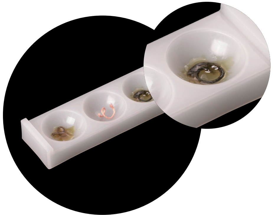
Abb. 11: In der linken Vertiefung: nicht imprägnierter Faden, getränkt in Eisensulfat (keine Verfärbung). In der mittleren Vertiefung: mit Adrenalin vorimprägnierter Faden, ohne zusätzliches Tränken (rosa). In der rechten Vertiefung: mit Adrenalin vorimprägnierter Faden, zusätzlich getränkt in Eisensulfat (blau-schwarze Verfärbung des Fadens auf Grund der Wechselwirkung).
