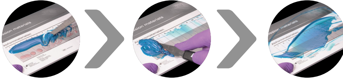
Abb. 60 – 62: Vormischen mit kreisenden Bewegungen, Aufnahme mit dem Spatel und breitflächiges Ausstreichen.
