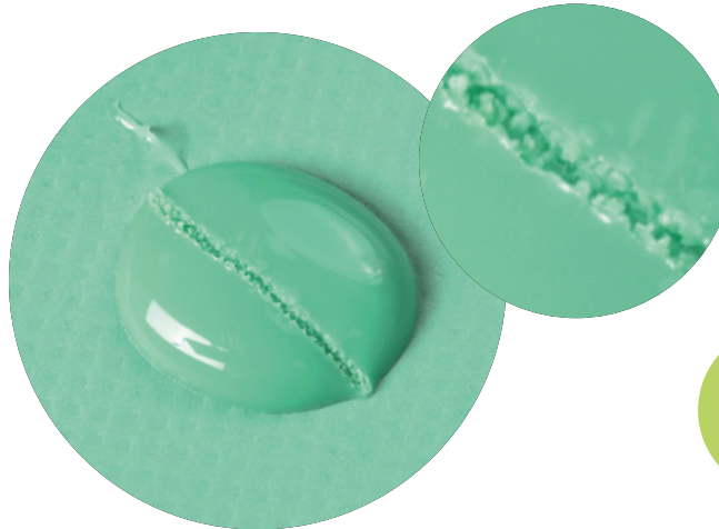
Abb. 22: Abwesenheit einer Schmier-schicht an der Kontaktstelle zeigt Kompatibilität der verwendeten Materialien.
