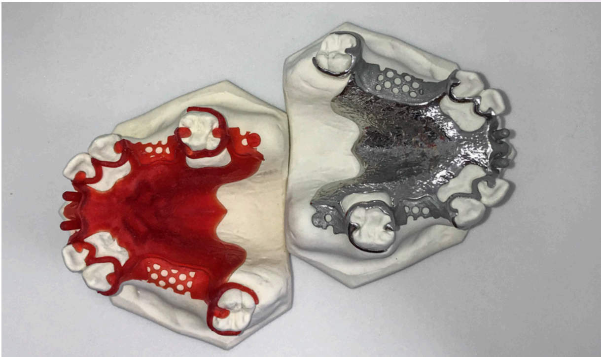
Links: Gedrucktes Gerüst mit dima Print Cast ruby Rechts: Das gleiche Gerüst aus gegossenem NPM
