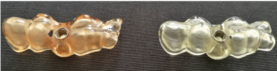
Nachgehärtete und polierte Bohrschablone vor dem Autoklavieren (links) und danach (rechts)
