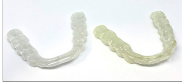
dima Print Splint clear-Schienen nach der Politur (links mit Filterscheibe und rechts ohne nachgehärtet)
